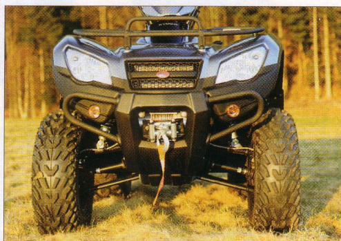
Bumper bien dessiné, treuil de série, porte-paquet pratique, on reprochera juste l'absence de protection de triangles.
