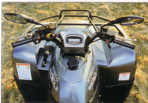
Un poste de conduite simple mais fort plaisant avec « parking cuillère », sélecteur de gamme confort, 4x2-4x4 au pouce droit...
